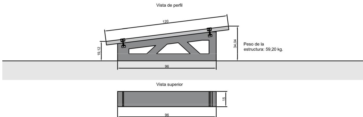
b) Estructura de hormigón 7º con panel solar en posición vertical. Con 2 lastres adicionales de 10x20x50 cm.
