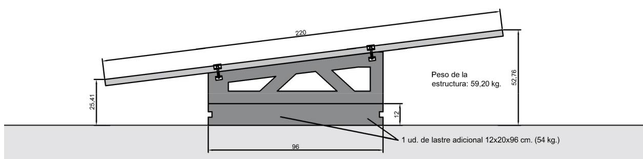
**ANCLAJE DE LOS PANELES SOLARES:** mediante omega de aluminio y tornillería de acero inoxidable, anclado a la hendidura existente en el soporte de hormigón.
