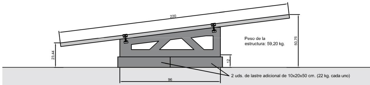
c) Estructura de hormigón 15º con panel solar en posición vertical. Con 1 lastre adicional de 12x20x96 cm.
