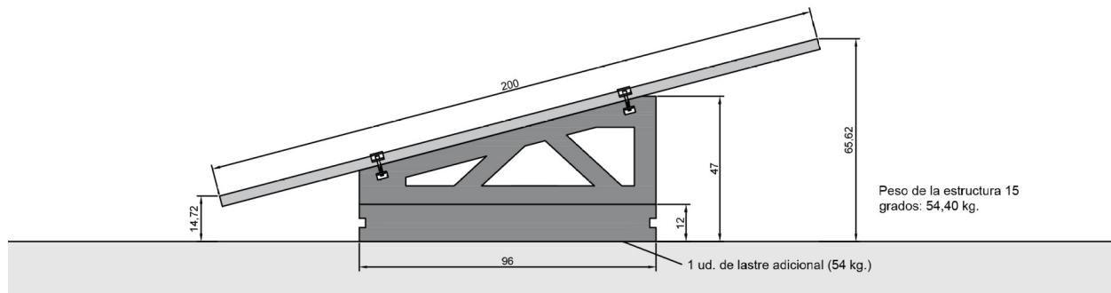
**ANCLAJE DE LOS PANELES SOLARES:** mediante omega de aluminio y tornillería de acero inoxidable, anclado a la hendidura existente en el soporte de hormigón.
