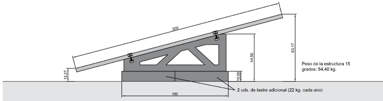
c) Estructura de hormigón 15º con panel solar en posición vertical. Con 1 lastre adicional de 12x20x96 cm.
