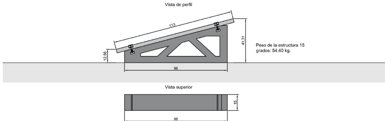
b) Estructura de hormigón 15º con panel solar en posición vertical. Con 2 lastres adicionales de 10x20x50 cm.
