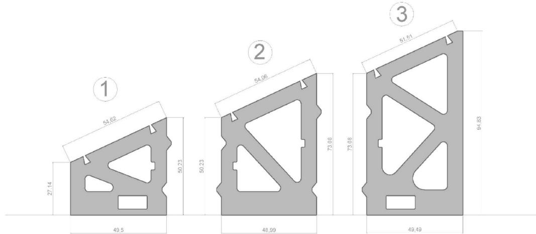
Dos paneles fotovoltaicos en posición horizontal por cada conjunto de dos estructuras.
