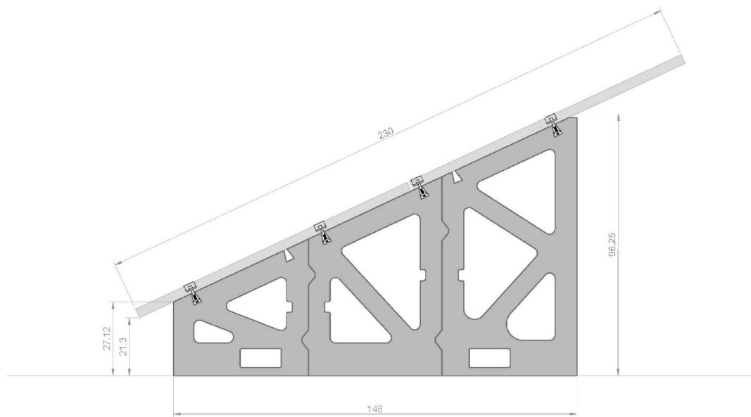
**ANCLAJE DE LOS PANELES SOLARES:** mediante omega de aluminio y tornillería de acero inoxidable, anclado a la hendidura existente en el soporte de hormigón.
