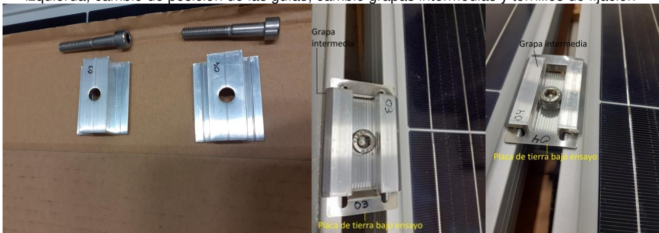
Fotografía 5: Montaje 5. Con dos piezas (ME-ITE-210653-03 y ME-ITE-21065301-04), tierra del panel fotovoltaico de la izquierda, cambio de posición de las guías, cambio grapas intermedias y tornillos de fijación
