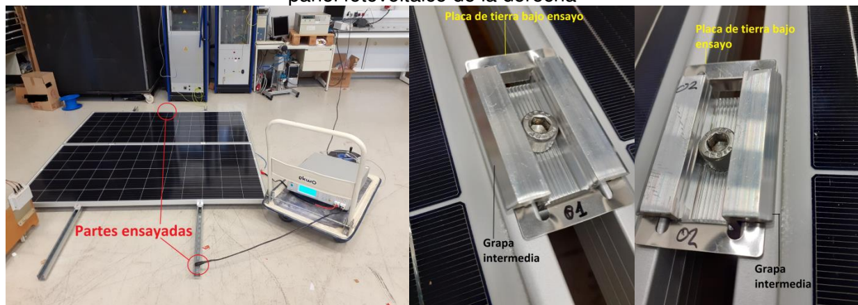
Fotografía 3: Montaje 3. Con dos piezas (ME-ITE-210653-01 y ME-ITE-21065301-02), tierra del panel fotovoltaico de la izquierda
